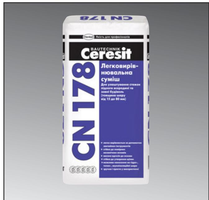
и заделываются растворной смесью Ceresit CN 178. При толщине слоя стяжки от 15 до 40 мм основание необходимо загрунтовать полностью. При толщине слоя выше 40 мм основание очищается от веществ, уменьшающих адгезию, и увлажняется, после чего укладывается слой Ceresit CN 178. При устройстве плавающих стяжек на разделительном слое толщина слоя должна быть не менее 40 мм.
